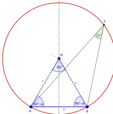
Abbildung 1.52: Konstruktion eines Kreises bei gegebener Sehne und gegebenem Peripheriewinkel
