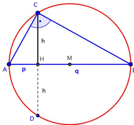
Abbildung 1.59: Aus dem Sehnensatz folgt der Höhensatz
