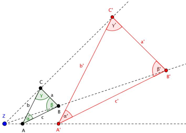
Abbildung 1.21: Streckung eines Dreiecks mit Faktor  $k = 3$
