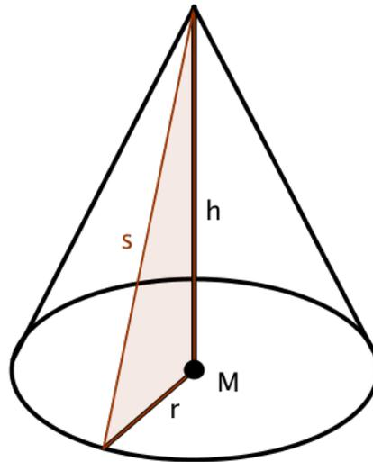
Abbildung 1.76: Kegel als Rotation eines Dreiecks um eine Kathete
