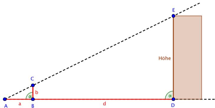
Abbildung 1.23: Höhenmessung eines rechteckigen Turms
